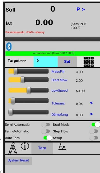
16. Durch betätigen dieser Taste wird die vollautomatische Systementleerung gestartet
